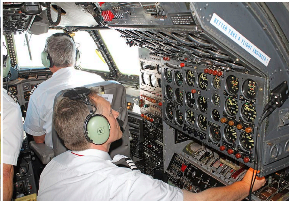
Cockpitatmosphäre: Der Flugingenieur überwacht und synchronisiert die vier Motoren während des Fluges.
